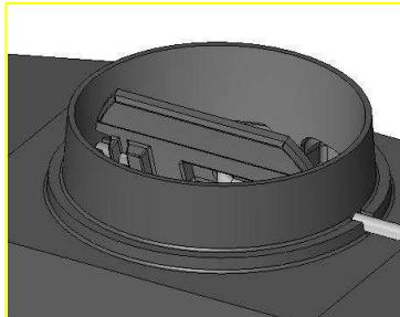
Механизм регулировки тяговой заслонки: открытое положение
