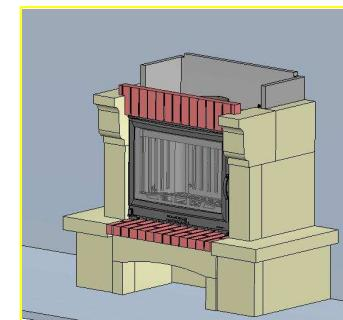
Типовой пример изоляции опорного основания и стены прилегания топки с помощью минераловатных панелей толщиной 30 мм.
