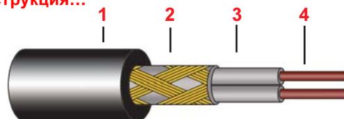
Двужильный экранированный нагревательный кабель с двойным покрытием и с внешней оболочкой UW-Protektion (стойкая к ультрафиолетовым лучам).
