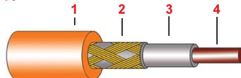
Экранированный нагревательный кабель с двойным покрытием и с внешней термостойкой оболочкой PVC.
