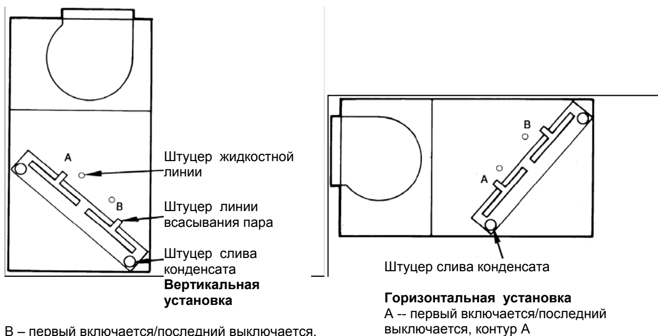
Рис. 6 – Стандартные штуцеры для подключения змеевика испарителя (40RU)
