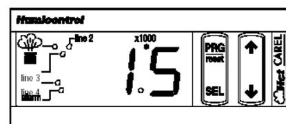
Обратите внимание, что расход воды на экране выражен в десятках. Например, при расходе воды 230 кг/ч на экране высвечивается число «23».
