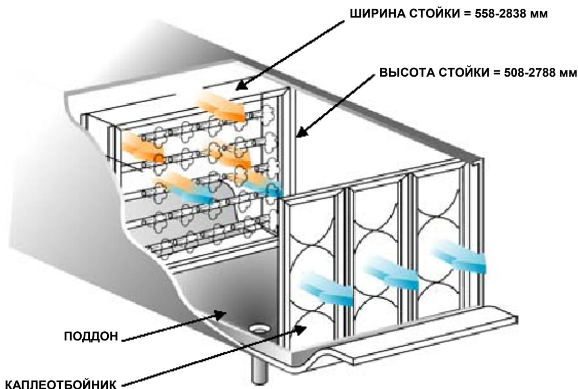
Каплеотбойник должен перекрывать все сечение воздуховода. Он устанавливается в конце секции увлажнения, чтобы не пропустить неиспарившиеся капли аэрозоля.
