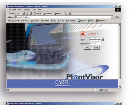
Важным аспектом является защита информации. Для входа в систему диспетчеризации PlantVisor необходимо пройти авторизацию. Каждый пользователь имеет свой логин и пароль. Уровень доступа для каждого пользователя может быть ограничен, например, только возможностью мониторинга или возможностью мониторинга и изменением уставок.
