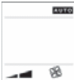
Рис. 2.m.f Автоматический режим с активной функцией комфорта
