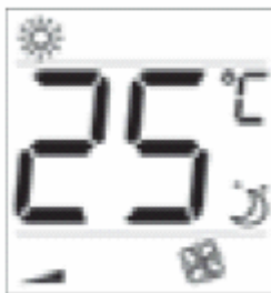
Рис. 2.m.h Вид дисплея с активированным режимом ожидания (SLEEP)
