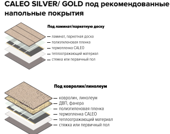
Рис. Схема монтажа теплого пола CALEO под ламинат, паркет, ковролин, линолеум
