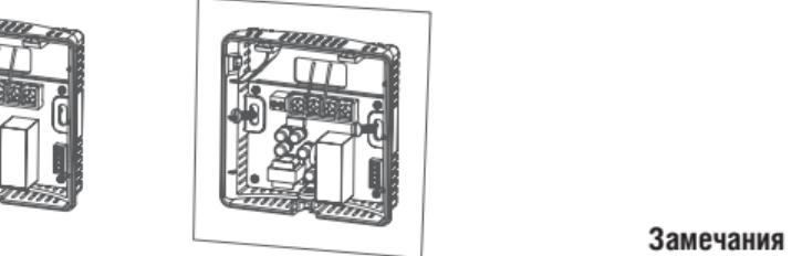
4. Закройте переднюю панель и закрутите винт, как показано на рисунках, чтобы закончить установку.
