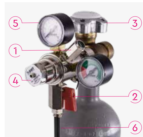
Рис. 10: Подключение баллона со сжатым CO 2
