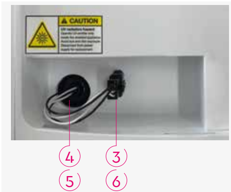
Fig. 12 : ouverture de la lampe UV sous le couvercle de l'AQA drink Pro 20
