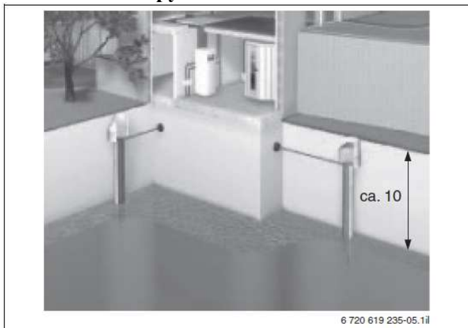
Рисунок 5 Сборные колодцы грунтовых вод (величины в м)
