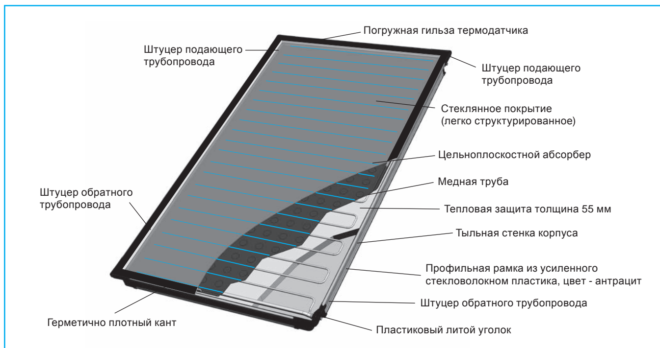
7/1 Устройство высокопродуктивного плоского гелиоколлектора Logasol SKS4.0-с (вертикального типа)
