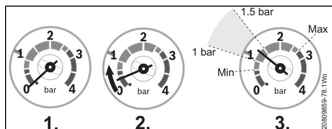
Рис. 28 Установка давления в системе
