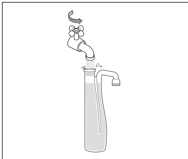
Рис. 16 Заполнение сифона водой
