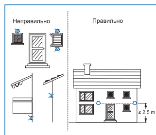
17/1 Место установки датчика наружной температуры
