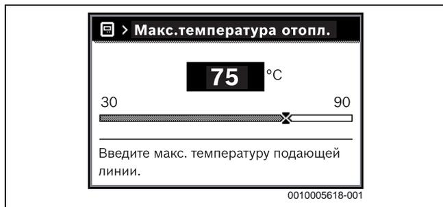
Рис. 61 Установка максимальной температуры подающей линии
