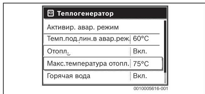
Рис. 60 Максимальная температура подающей линии
