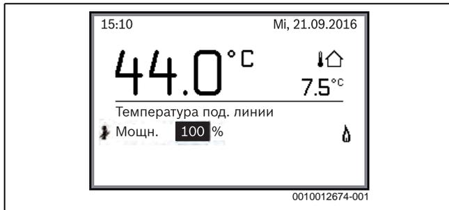
Рис. 63 Режим "Тест дымовых газов" активирован
