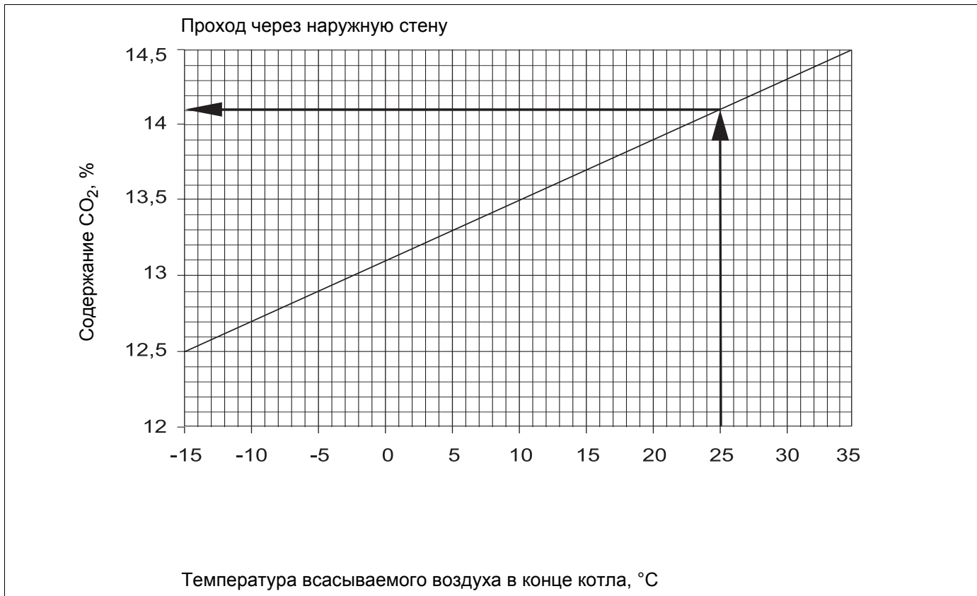
Рис. 6 Регулировка содержания CO 2 в зависимости от температуры всасываемого воздуха при непосредственном поступлении воздуха через наружную стену (действительно как при наличии кожуха горелки, так и без него)
