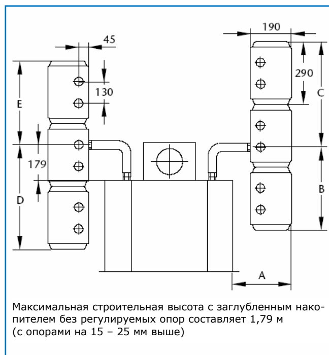
26/3 Варианты размещения комплекта подключения котла KAS 2/G134, а также комплектов ES 2 и ES 3 с газовым чугунным отопительным котлом Logano G134 multigas (размеры в мм; величины → 26/2)
