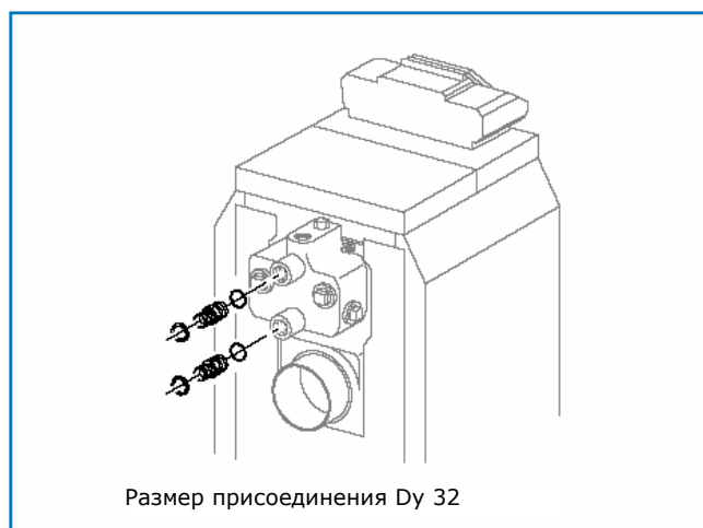
12/2 Комплект подключения AS/G215 с газомазутным чугунным отопительным котлом Logano G215
