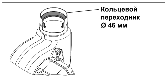
Рис. 19 Подгонка кольцевого переходника
