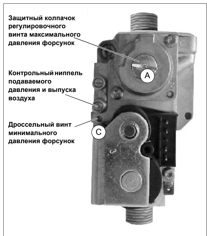
Рис. 43 Настройка давления форсунок
