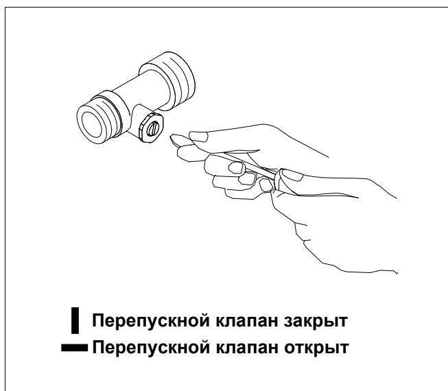
Рис. 29 Настройка перепускного клапана
