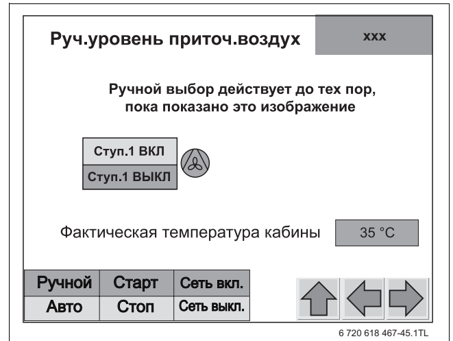
Рис. 40 Ручной уровень „Приточный воздух“
