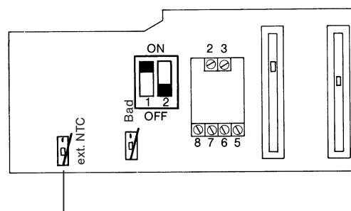
Переключатель внешн. NTC: открыт при расположенному отдельно датчике комнатной температуры
