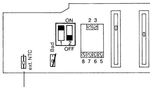
Переключатель внешн. NTC: закрыт при встроенном датчике комнатной температуры; заводская установка
