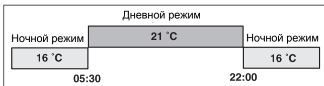
Рис. 9 Нормальный (дневной) отопительный режим и отопительный режим с пониженной температурой (ночной режим)
