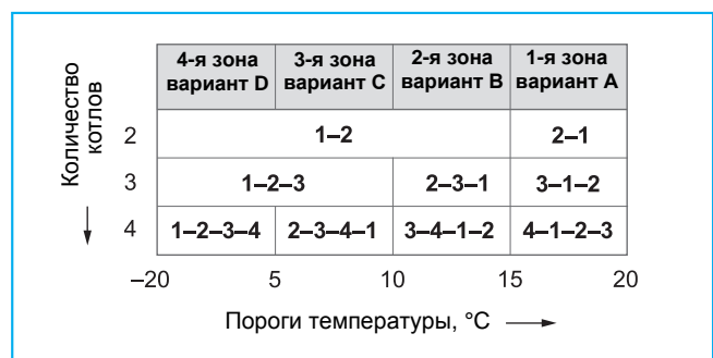
142/2 Последовательность включения котлов через функциональный модуль FM458 в зависимости от наружной температуры
