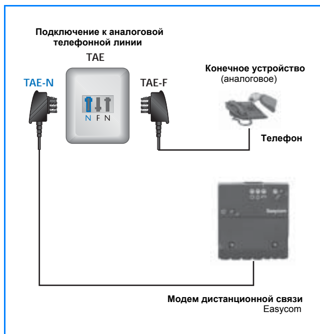
52/1 Розетка TAE „N-F-N“ параллельного аппарата с отдельным подключением для модема дистанционной связи Easycot или Easycot PRO (кроме GSM)
