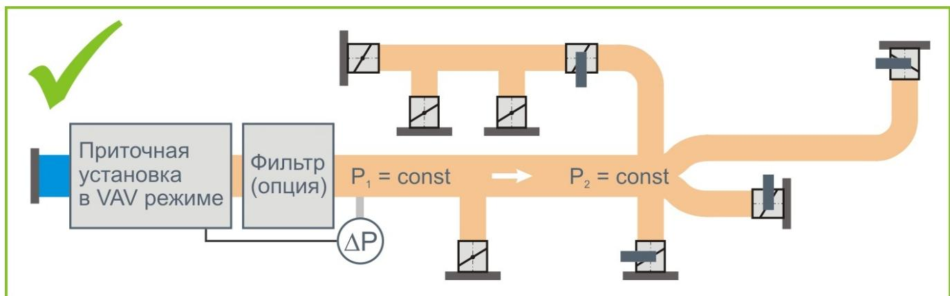
Рассмотрим этот пример подробнее. После вентустановки расположен фильтр тонкой очистки (может не быть). По мере загрязнения фильтра его сопротивление будет расти. Однако в отличие от обычной системы вентиляции расход воздуха при этом меняться не будет, поскольку вентустановка поддерживает постоянное давление в воздуховоде после фильтра. Таким образом, дополнительным преимуществом VAV системы является компенсация изменения сопротивления воздушного фильтра.
