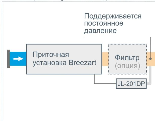
Воздухопроводная сеть с регулируемыми зонами
