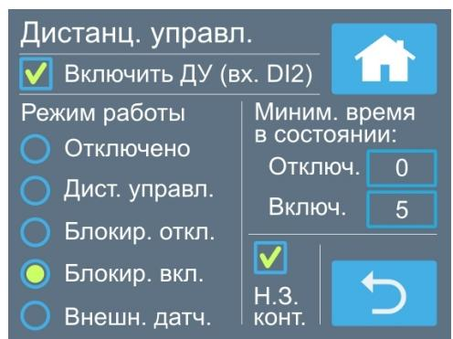
При активации режима удаленного управления включение / отключение вентустановки с пульта (в том числе по сценариям) может быть заблокировано. В этом состоянии кнопка включения / отключения становится неактивной (серой). При блокировке включения в поле сценариев появляется символ  $\otimes$ , показывающий, что сценарии в данный момент отключены.
