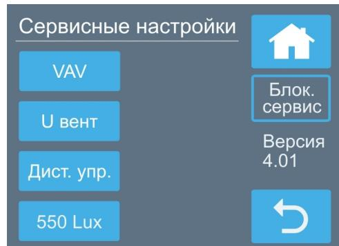
Когда окно «Сервисные настройки» открыто, блокируется автоматический переход экрана в режим скринсейвера и отключается отправка запросов по шине ModBus. Это позволяет подключать к шине ModBus другие устройства управления (панель Weintec или адаптер BSA для управления через утилиту BSU) без необходимости отключения основного пульта управления.
