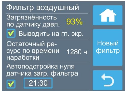
Второй параметр – это оставшийся ресурс воздушного фильтра, который рассчитывается исходя из времени работы вентустановки (справочное значение, которое на работу вентустановки никак не влияет). При замене фильтра рекомендуется инициировать счетчик времени наработки фильтра, нажав кнопку **«Новый фильтр»**.
