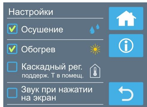
При включении опций «Осушение», «Обогрев», «Каскадный регулятор» на основном экране будут отображаться соответствующие пиктограммы.
