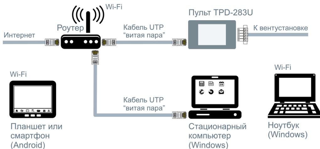
Пульт **TPD-283U** подключается сетевым кабелем с разъемами RJ-45 (8P8C) к роутеру. На роутере должен быть активирован **DHCP**, чтобы пульт мог получить IP адрес.
