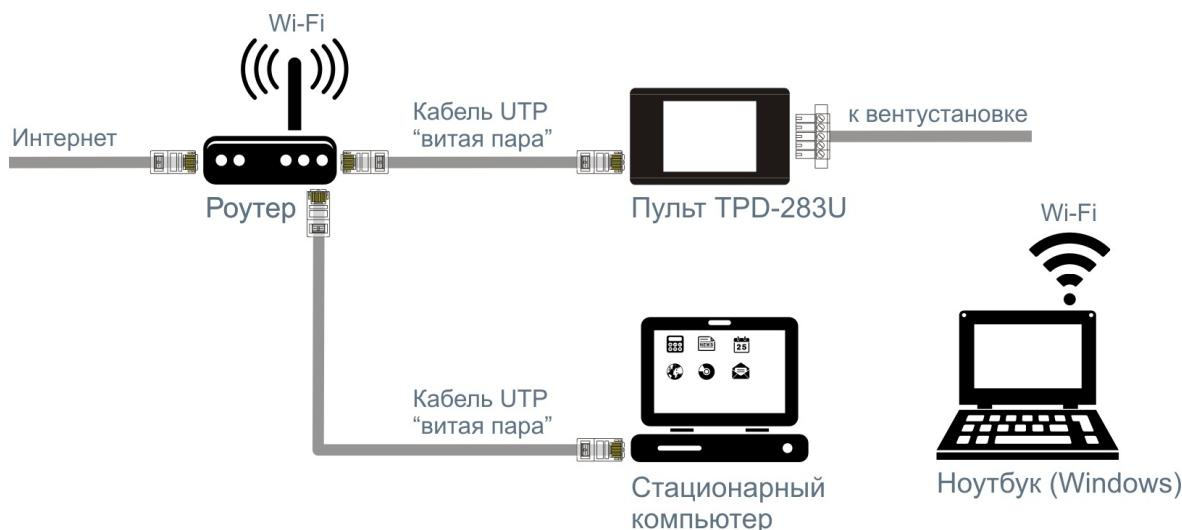
Пульт **TPD-283U** подключается сетевым кабелем с разъемами RJ-45 (8P8C) к роутеру. На роутере должен быть активирован **DHCP**, чтобы пульт мог получить IP адрес.
