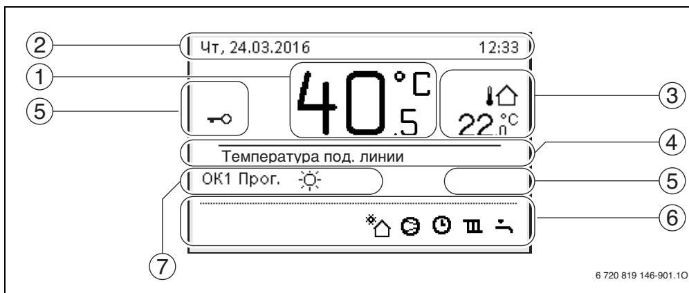
Рис. 4 Пример стандартной индикации в системе с несколькими отопительными контурами
