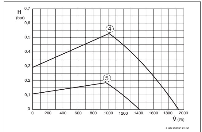
Рис. 63 Режим пропорционального давления со встроенным насосом
