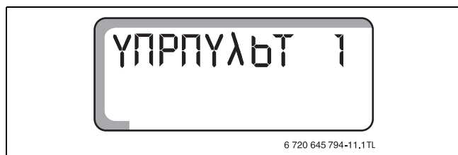
Рис. 11 Дистанционное управление подключено
