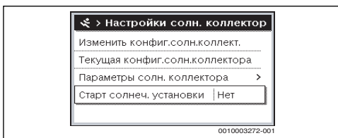
Рис. 8 Меню "Настройки солнечного коллектора"
