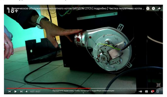
Открутите 3 самореза и отсоедините дымосос от корпуса, (предварительно отметив маркировку контактов).
