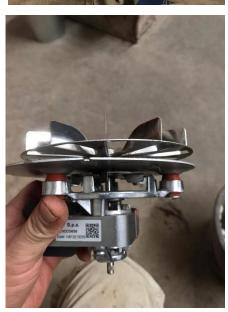
Очищенный и сухой вентилятор дымосос ставится на место с предварительно нанесённым термостойким герметиком (400С) по радиусу посадки.
