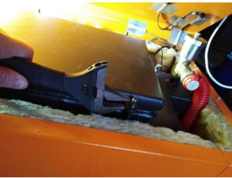
Внутренние гайки М8 (4шт) на удерживающей плиту пластине, надо аккуратно подтягивать, чтобы устранить люфт между прижимной плитой и крышкой. Соблюдать осторожность что бы не повредить плиту вермикулита. Если на плите есть сколы, трещины или жаропрочные винты сломаны- заказать у Поставщика замену.
