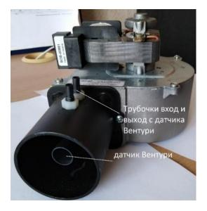
**Ревизия и очистка в камере сгорания** - Очистить трубку прессостата безопасности в камере сгорания. (сняв пвх предварительно!)
