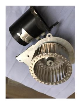
Установить вентилятор на место, Проверить уплотнение фольгированной лентой на вентиляторе подачи воздуха Fan 1 - это важно!
