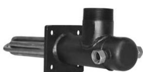
Аварийный теплообменник устанавливается непосредственно в подающий патрубок котла. В наружной части теплообменника имеются два штуцера для присоединения терmostатического предохранительного клапана и для отвода горячей воды.
