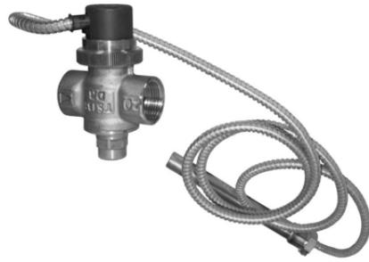
Терmostатический регулирующий вентиль срабатывает по температуре воды в котле. Он состоит из клапана со сжатой пружиной и сильфонного датчика температуры. Когда температура в котле достигает 95°C, усилие, оказываемое сильфоном, превышает усилие, развиваемое пружиной, и она распрямляется. Холодная вода из водопровода начинает поступать через аварийный теплообменник. Таким образом, снимается избыточное тепло, и котёл не перегревается.
