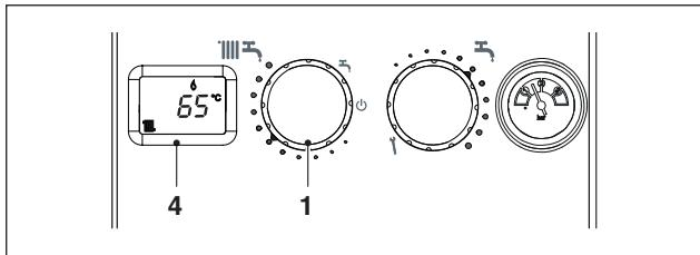
**⚠️** Функции связанные с производством горячей воды активируются только при подключении к котлу аксессуара "Датчик NTC бойлера" и загрузочного насоса бойлера (см. главы "Принципиальная электрическая схема" и "Электрические подключения").
