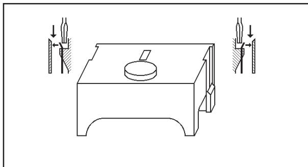
На своих сторонах цоколь имеет эластичные пластиинки (собачки), которые застегиваются в коробке при насадке корпуса. Для того, чтобы освободить корпус, достаточно легкого раскачивающего движения с помощью отвертки (см. рисунок ниже) в направляющих прорезях этой задвижки (корпус немного приподнимается).
