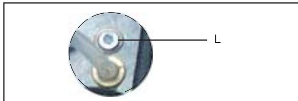
Регулировка по мощности генератора: с помощью шестигранного ключа № 4, повернуть регулировочный винт у отметки Y в том или ином направлении в зависимости от желаемой регулировки
