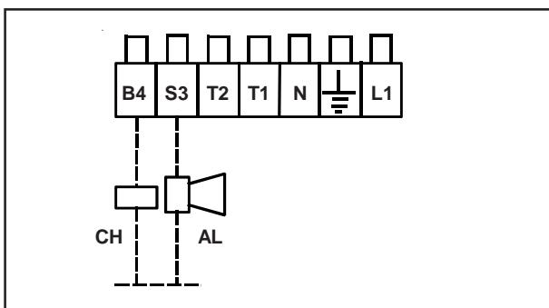
Подключение счетчика времени и сигнала тревоги производится клиентом.
