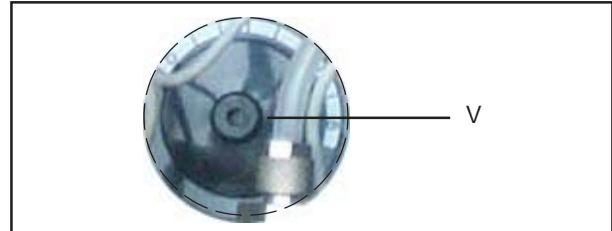
Регулировка по мощности генератора : с помощью шестигранного ключа № 4, повернуть ручку регулировки репера V в том или ином направлении в зависимости от желаемой настройки. Выемки на ручке и на картере позволяют блокировать ручку в определенном положении.
