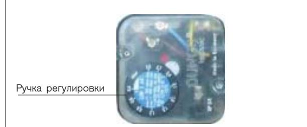
Воздушный маностат настроен на минимум на заводе. Контакт (COM-NO) устанавливается при вращении вентилятора (нормальное давление воздуха). Сбой включения маностата вызывает включение предохранителя горелки. Рифленая ручка, отградуированная в мбараах, позволяет отрегулировать обрыв. Эта регулировка должна проводиться на подставке, чтобы добиться срабатывания отключения или предохранения горелки еще до того момента, когда содержание CO достигнет разрешенного уровня в 1%.
