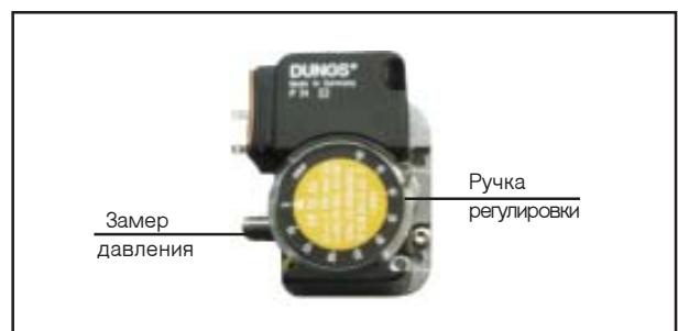
Это давление отрегулировано на заводе на 15 мбар. Чтобы уточнить эту настройку, воспользуйтесь ручкой регулировки в соответствии с приведенной таблицей.
