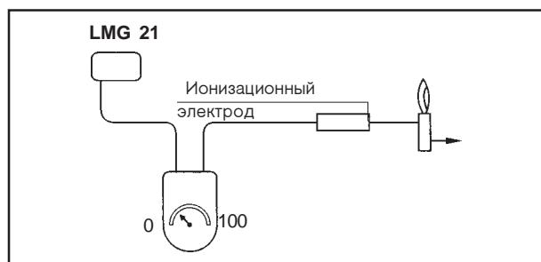
**Замечание :** В том случае, если стрелка амперметра отклоняется в неверном направлении (ниже нуля), нужно поменять местами 2 провода измерительного прибора. Провод «плюс» на место провода «минус» и наоборот.
