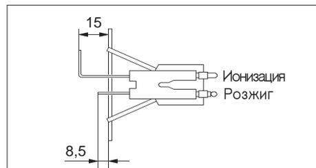
Электроды регулируются на заводе как показано на рисунке выше. Следите за центровкой электрода ионизации в отверстии у основания пламени. (Должна устраняться опасность его замыкания на массу).
