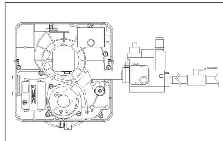
Для подключения газовой ramпы к газораспределительной сети использовать запорный кран\* и трубчатый раккорд (поставляется в упаковке). Плечо рычага газовых труб не должно создавать чрезмерных нагрузок на картер. Проверить герметичность.
