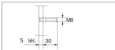
Используя штифты из комплекта принадлежностей, поставляемого вместе с горелкой, установить их в соответствии со схемой выше.
