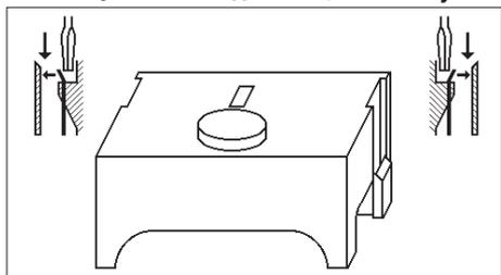
По обеим сторонам цоколя имеются эластичные язычки, прячущиеся в короб при надвигании кожуха. Чтобы его освободить, достаточно легкого толчка отверткой (см. рисунок выше) по направляющим канавкам запора (кожух немного приподнимается).
