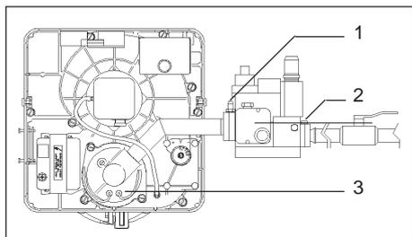
1 Датчик давления на выходе клапана
