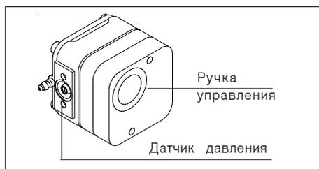
Отключение этого реле вызывает не перевод горелки в режим безопасности, а переход клапан газа на 1-ю скорость. Горелка на 2-й
