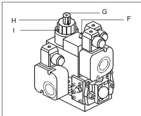
Для изменения расхода газа предпочтительно пользоваться регулятором. При необходимости, для изменения регулировки клапана, отпустить болт I (не лакированный) примерно на 1 оборот. Отрегулировать расход вращением кольца H. Вращение по часовой стрелке (в сторону H) уменьшает расход, а против часовой стрелке (в сторону H) — его увеличивает. Затянуть болт I, затем проверить горение. При необходимости повторить операцию.
