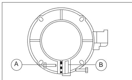
Полностью выкрутить болт А. Этот же болт вкрутить в отверстие В. Фланец отодвигается, обеспечивая удобную сборку и разборку горелки. Для выполнения этой работы надо слегка отпустить гайки крепления фланца на горелке.
