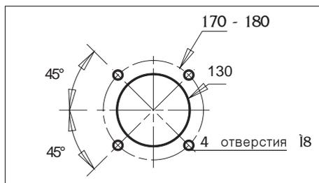
Просверлить отверстия в панели котла в соответствии со схемой выше.
