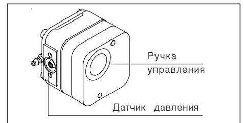
Контакт устанавливается при работающем вентиляторе (нормальное давление воздуха). Невключение реле давления воздуха переводит горелку в режим безопасности. Ручка с накаткой, проградуированная в миллибарах, позволяет, при необходимости, регулировать давление отсекания.
