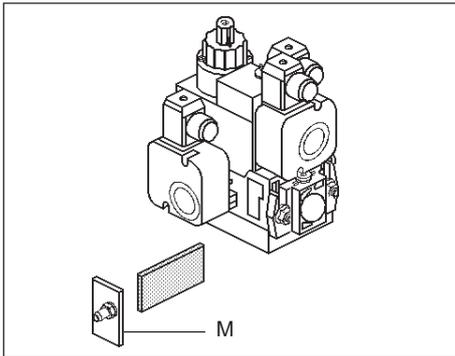
Снять колпак М (торцовый ключ на 3). Снять фильтр и, при значительном загрязнении, заменить его. Если он загрязнен незначительно, промыть водой с мягким моющим средством при температуре 40°C. Тщательно высушить фильтр прежде, чем приступить к монтажу.
