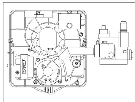
Вывинтить крепежные болты кожуха и снять его. Снять пробки обтюраторы и установить блок газа на соединительную трубку с установкой фланца (металл к металлу). Выполнить электрические подключения блока: соединители серого цвета, отметки "минимум" и "максимум" на соответствующих реле давления и соединитель черного цвета на клапане.
