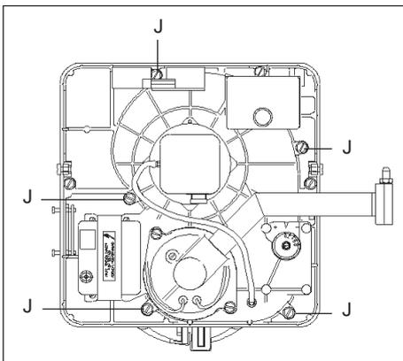
Снять трубку датчика давления воздуха. Открутить 5 болтов J крепления полу-вольюты. Снять вентиляционный элемент. Не снимая турбины, очистить ее кисточкой.
