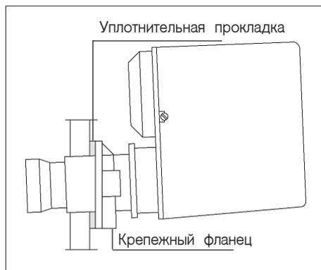
Обязательно соблюсти указанное положение горелки. С наклоном  $1^{\circ}30'$  установить крепежный фланец на панели котла, соблюдая пометку "ВЕРХ" ("HAUT"). Уплотнительную прокладку установить между фланцем горелки и панелью котла.
