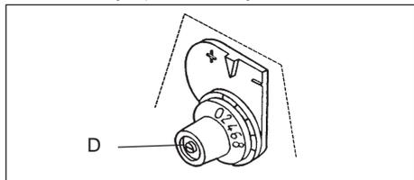
Отпустить болт С, установить заслонку на требуемую отметку, затянуть болт D.
