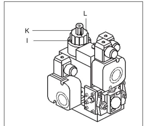
Снять болт I с фрезерованной головкой и болт L с цилиндрической головкой (см. рисунок). Поворачивая, снять крепежный диск К. Снять диск крепления и извлечь катушку. Сборку производить в обратном порядке.
