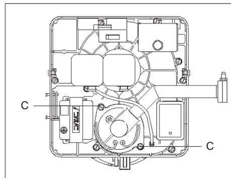
Отключить провод высокого напряжения трансформатора и провод ионизации от соединителя. Освободить винты C крепления форсунки.
