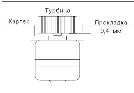
С помощью прокладки толщиной 0,4 мм проверить регулировку турбины.
