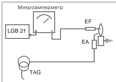
Разомкнуть соединения кабеля ионизации. Подключить микроамперметр постоянного тока между двумя соединителями соответственно схеме выше. Минимальное значение тока ионизации:  $\mu A$ .
