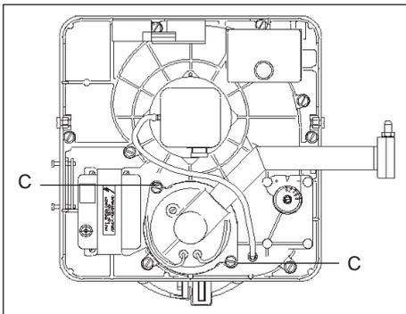
Отключить провода высокого напряжения и ионизации. Отпустить два болта С, которыми крепится газовая рампа. Снять форсунку. Очистить трубы распределения газа и стабилизатор.
