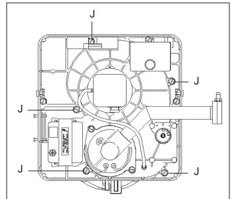
Отключить кабель двигателя от его соединителя. Снять трубку датчика давления воздуха. Открутить 5 болтов J крепления полу-вольюты. Извлечь фильтрующий элемент. Снять турбину с помощью отвертки с торцовым наконечником на 4 (болт на сердечнике, доступ отвертки к нему через крыльчатку). Установить на место новый двигатель, следуя указаниям, вставить турбину, следуя указаниям § 9.4) и в обратном порядке проделать описанные выше операции.
