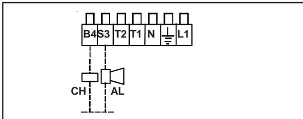
Подключение счетчика времени и сигнала тревоги производится клиентом.
