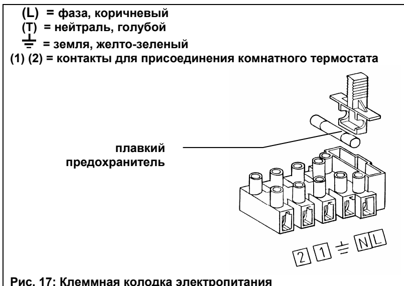
Рис. 17: Клеммная колодка электропитания
