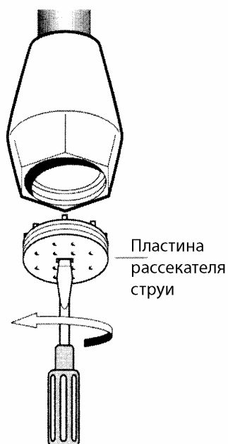
Рис. 14 Очистка пластины рассекателя струи
