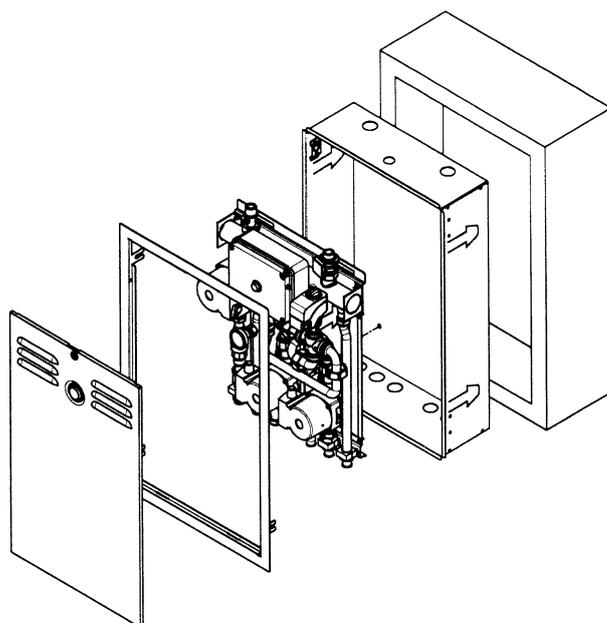
Рисунок 1: установка прибора в монтажном ящике
