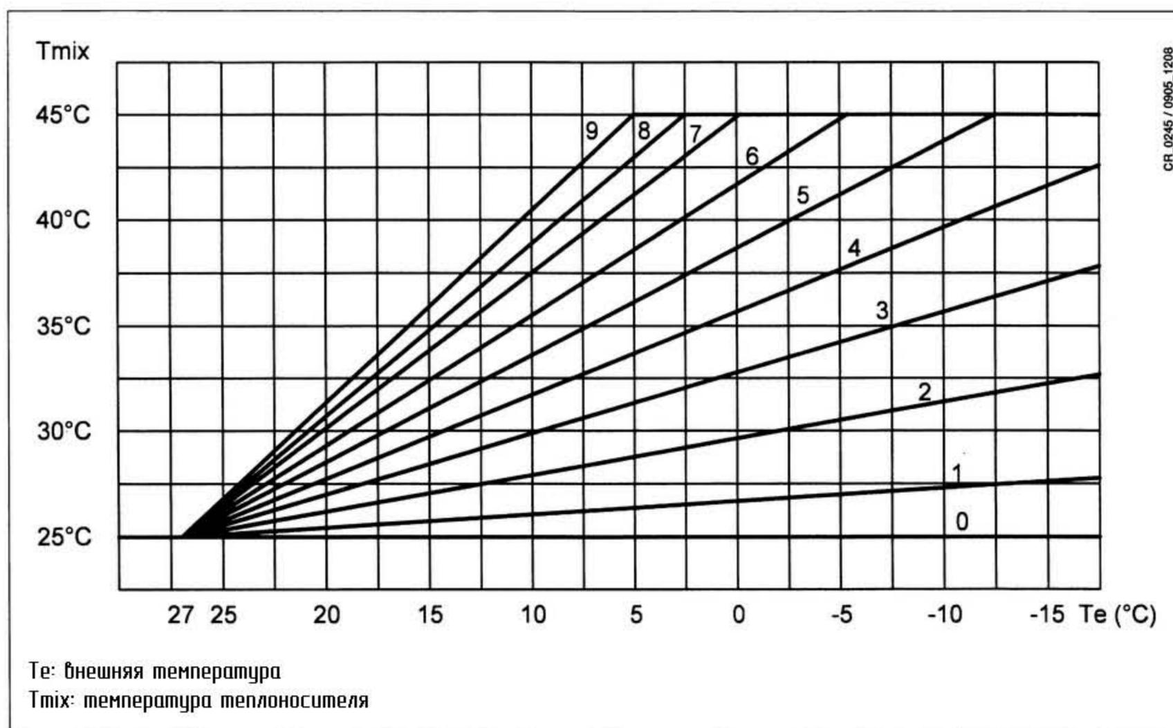
Для адаптации температуры, в несмешанной зоне (высокотемпературная зона), к изменениям температуры наружного воздуха, необходимо также оборудовать котел датчиком внешней температуры. При одновременном наличии климат-контроля и датчика внешней температуры, температура первой смешанной зоне будет ниже, чем это предусмотрено (задано) с самого управления климат-контролем и потенциометрами P1 и P2 на плате управления MS IN
