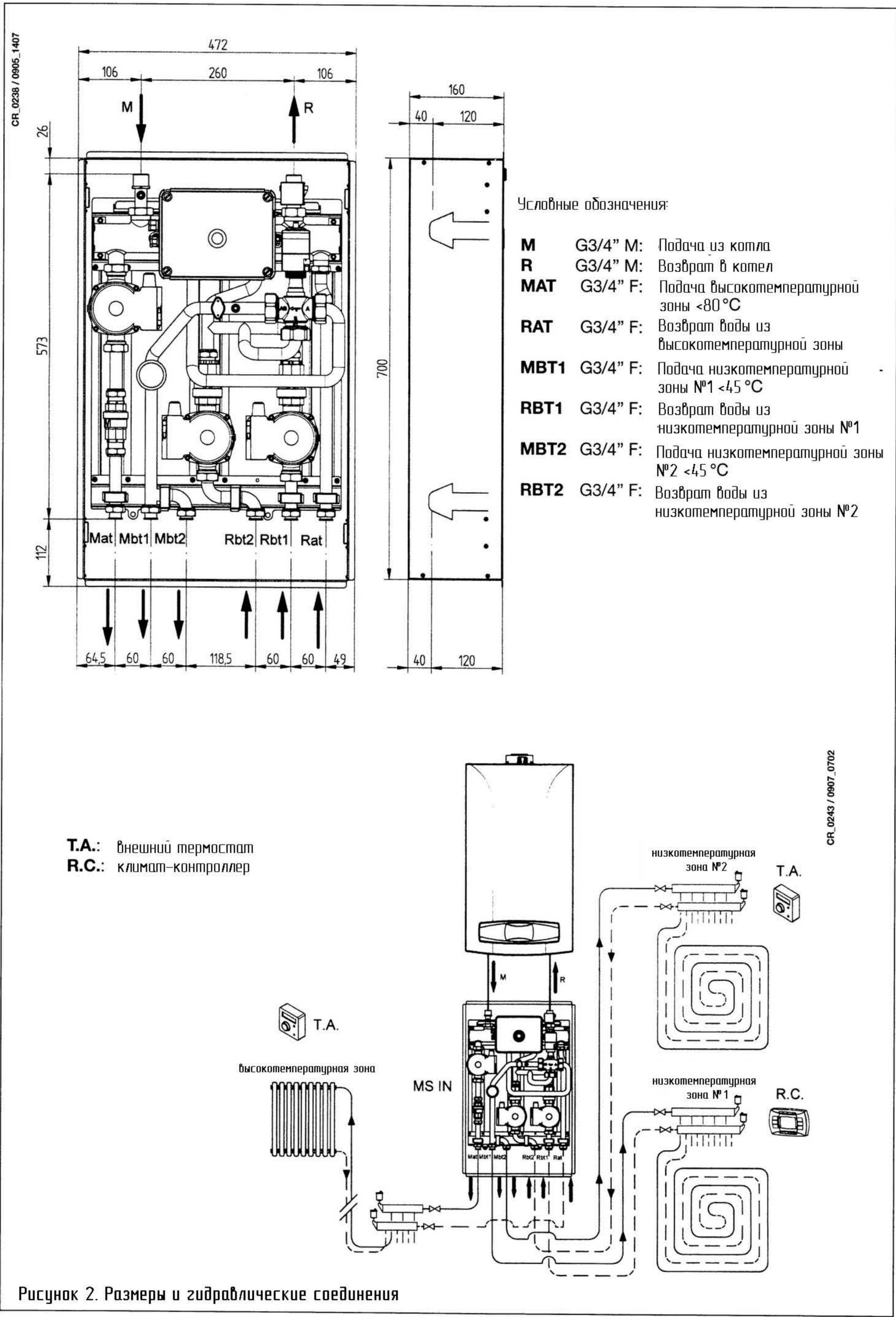
Рисунок 2. Размеры и гидравлические соединения
