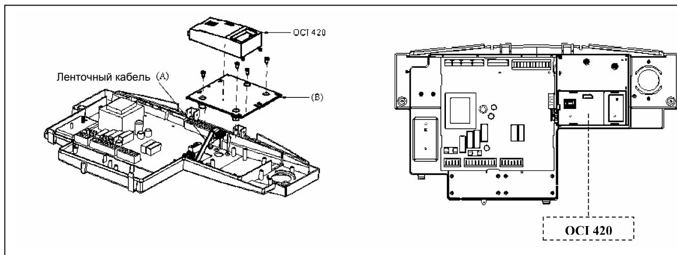
**Внимание:** Для облегчения присоединения аксессуара к электронной плате, подключайте кабель (A) к электронной плате до фиксации опорной площадки (B). Для точной установки крышки блока управления, на ней необходимо срезать два пластиковых штырька, которые расположены напротив модуля OCI 420.
