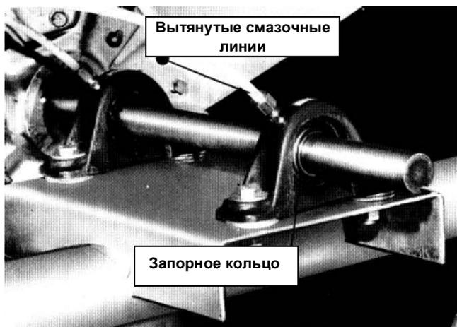
Рисунок 3 - Шарикоподшипник
