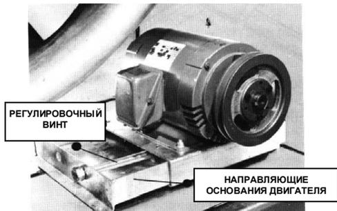
Рисунок 5В — Регулируемое основание двигателя
