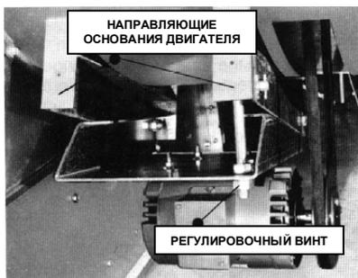
Рисунок 5А – Регулируемое основание двигателя
