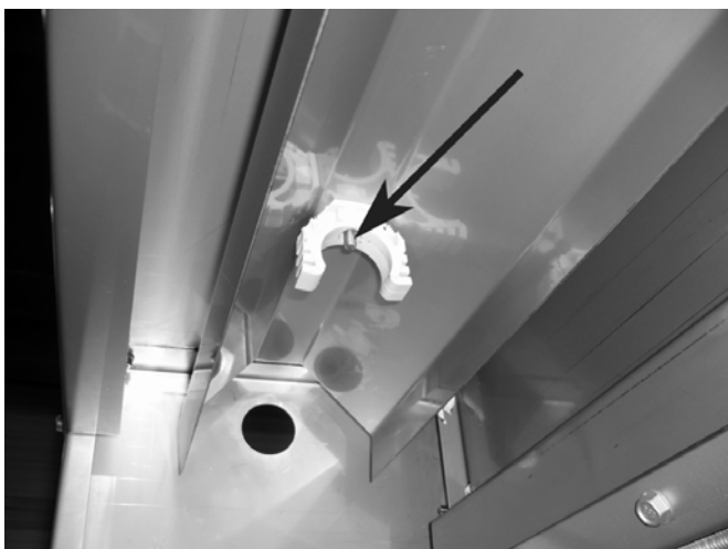
Рисунок 11: Пластиковый держатель с более длинным болтом
