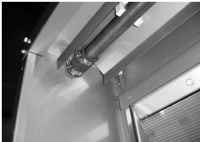
Рисунок 5: Соединение гибкого рукава
