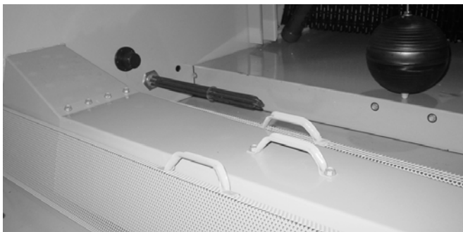
Рисунок 2: Бассейн холодной воды и сетчатый фильтр бассейна
