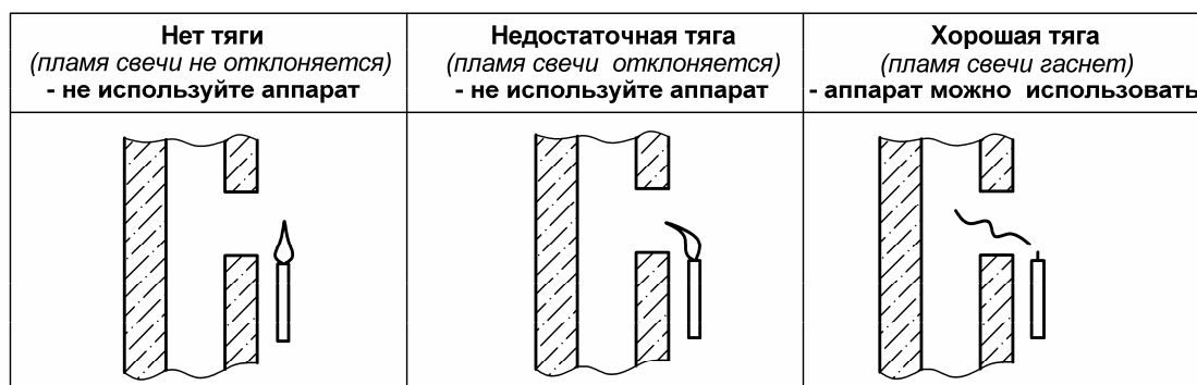
Рисунок 4. Способ проверки тяги в дымоходе
